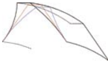
A distorção do flanco com fresamento de roscas com forma em Relevo com diversos ângulos de saída
