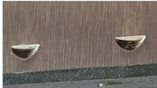
Marcas no mordente 58 HRC fixando com 40 [kN]
