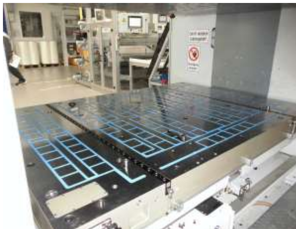
Prensa transportadora de moldes até 130 graus - Materiais compósitos de fibra de vidro
