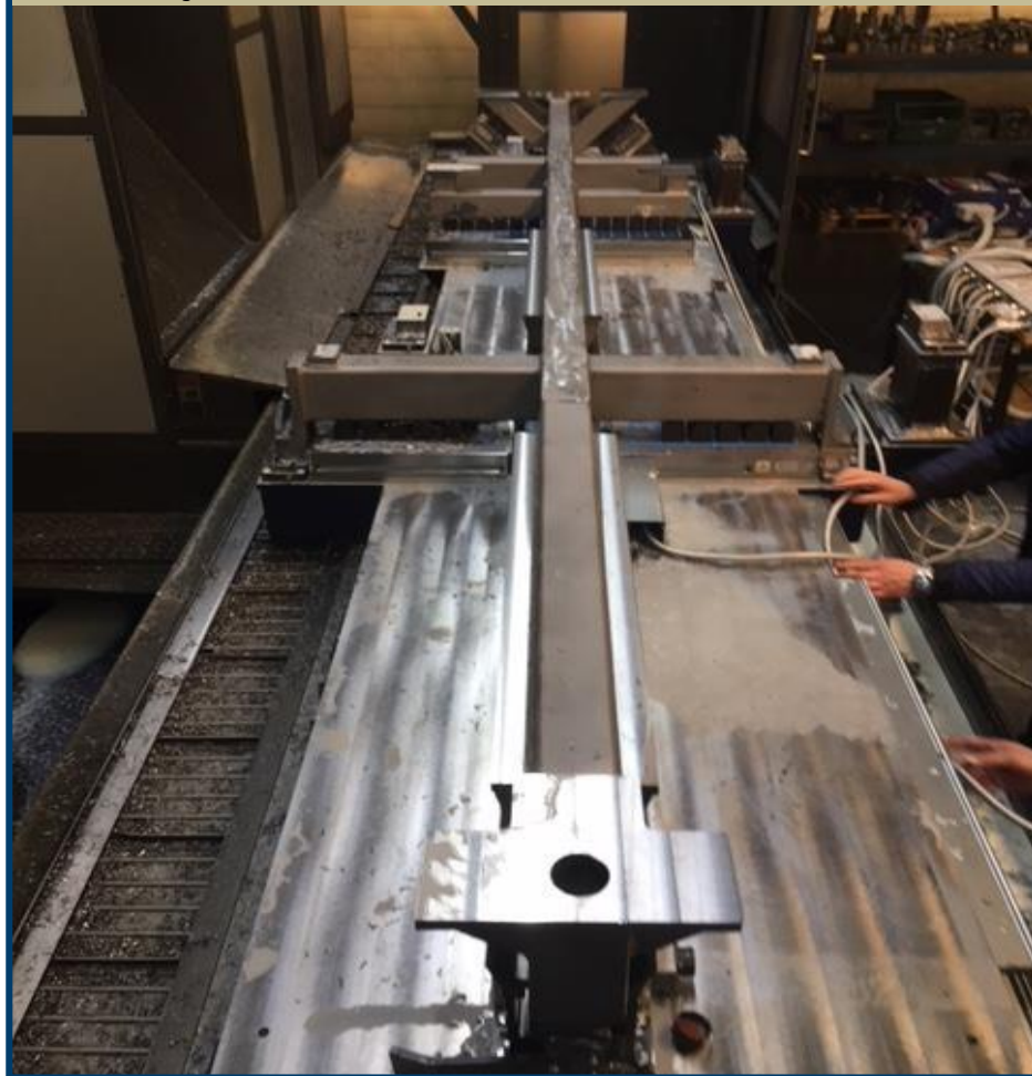
Prolongadores de polos móveis promovem fixação livre de deformação
