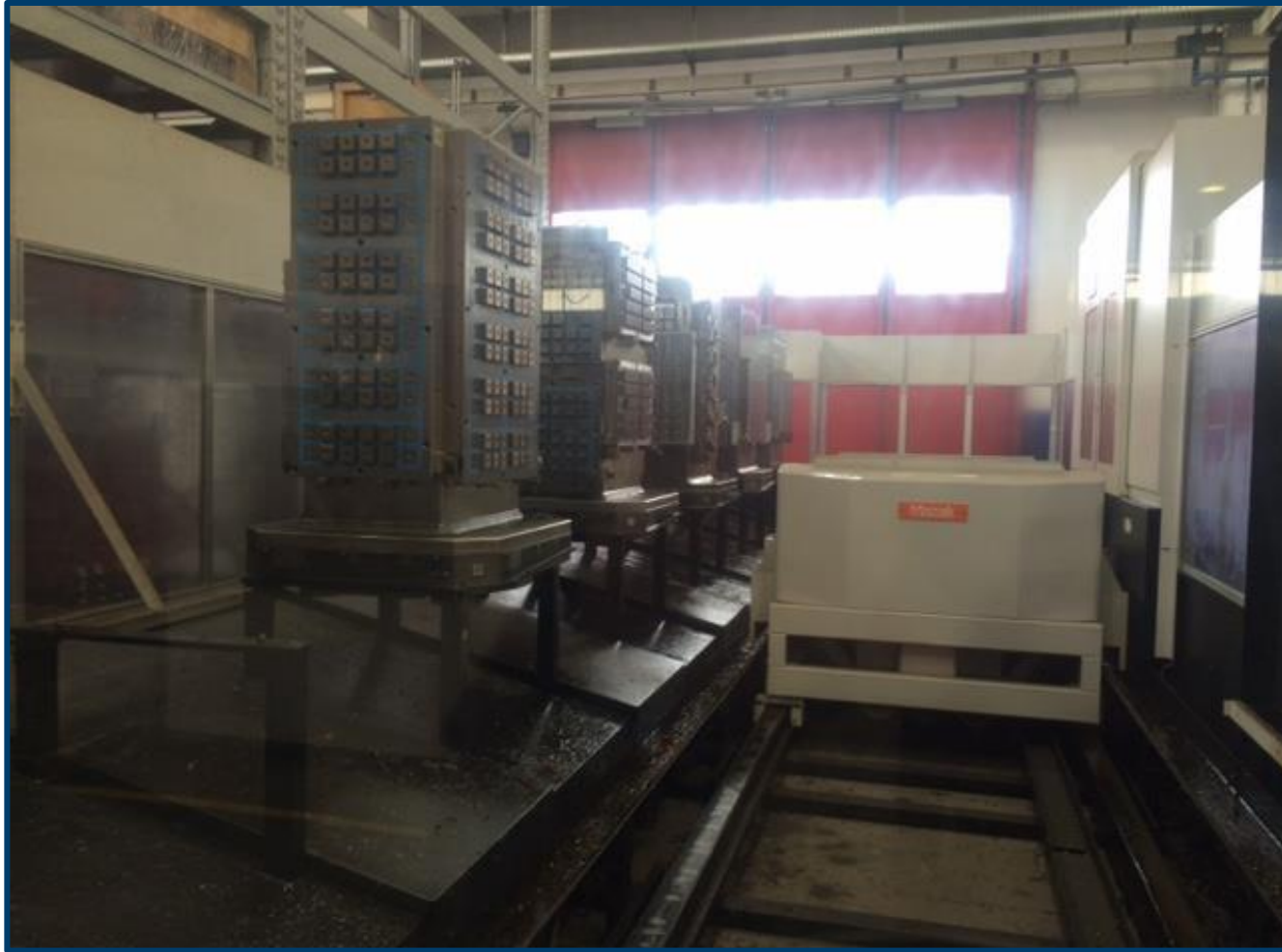
TOMBSTONE 4 lados em prateleiras para manter a máquina operando sem parada do spindle
